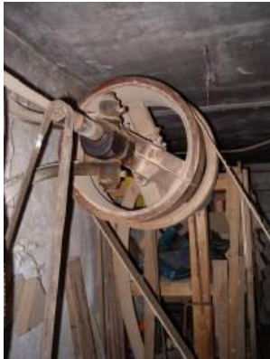
Die Transmission mit Riemenrädern aus Holz funktioniert noch genauso wie der Rundhobel.
